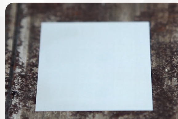
レーザーによる錆除去
