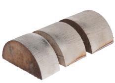
厚いステンレス鋼 の切断
