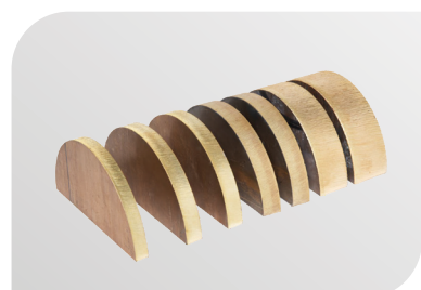
高反射材料の切断
